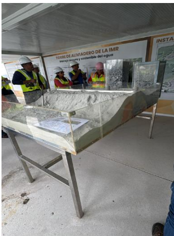
Fotografía 7-39 Modelo a escala de la torre de aliviadero
