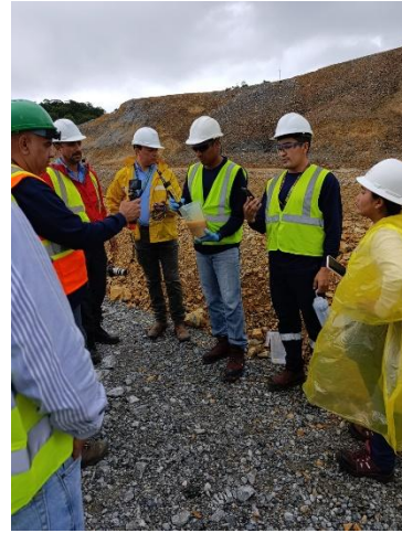
Fotografía 7-13 Detalle de material del botadero - Ensayo de acidez
