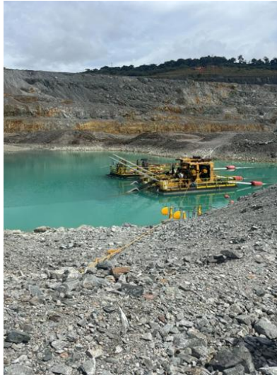
Fotografía 7-8 Sistema de bombeo en el sumidero del fondo del tajo
