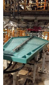
Equipo concentrador gravimétrico de minerales auroargentíferos.
