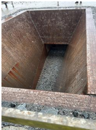
Fotografía 5-20 Vista interior tolva de alimentación
