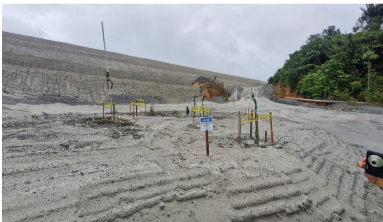
Fotografía 5-65 Monitoreo de taludes de la IMR, mediante piezómetros e inclinómetros
