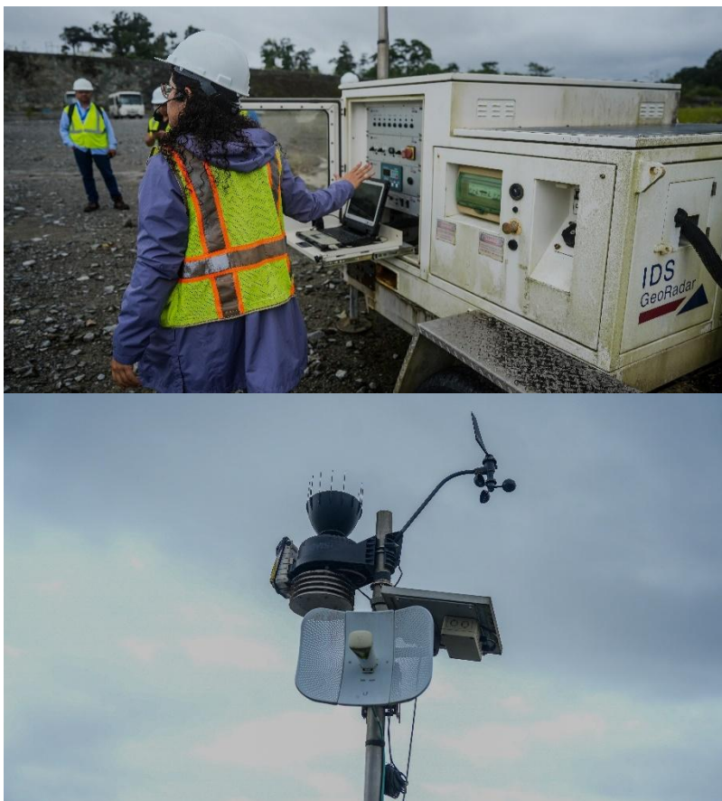
Fotografía 5-64 Sistema de Monitoreo de taludes en tajo Botija, mediante Georadar y monitoreo topográfico
