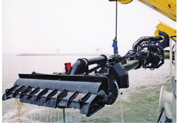
Rastra y tolva de protección para los sedimentos
